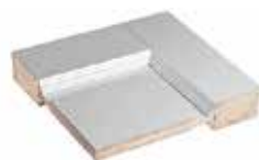
Craft-massivipeiliovi Kehys sormijatkettua puukuitule- vyllä vuorattua massiivipuuta, peilit maalattua MDF-levyä
