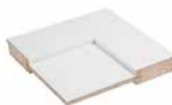
Unique-massivikehysovi Kehys sormijatkettua puukuitule- vyllä vuorattua massiivipuuta, peilit maalattua 12 mm lastulevyä
